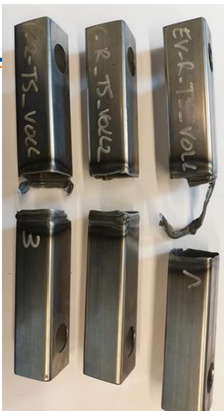
Figure 6: Essais de traction sur des tubes entiers
