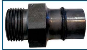
Fig. 7: soudage d'un tube et d'un raccord: élément d'un engin de terrassement (diam.: 27 mm, épaisseur de paroi: 3,2 mm, temps de soudage: 5 sec) (Source: Institut de Soudage Paton)
