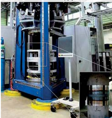
Figure 12: configuration d'essai MIAB pour le soudage de tubes de sondage (Source: Université Leibniz de Hanovre) [2]
