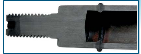
Figure 8: tige de piston soudée (diam.: 22 mm, épais. de paroi: 2,2 mm, temps de soudage: 3,6 sec) (Source: Institut de Soudage Paton)
