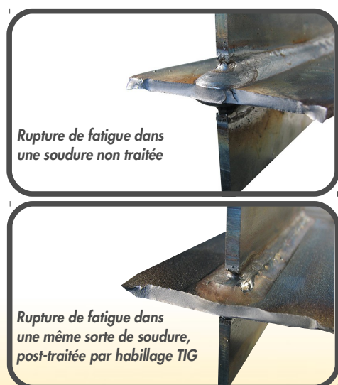
Figure 1: la soudure post-traitée a atteint une durée de vie plus élevée dans un essai de fatigue
