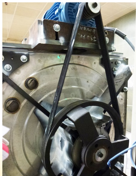
Figure 6: boîtier de roulement HF900 prêt pour l'essai out-of-balance
