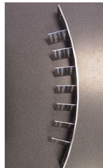
Figures 1 et 2: Application de micro-soudage robotisé par friction malaxage. Les résultats obtenus ont été très encourageants. En effet, l'étanchéité de la soudure et d'excellentes propriétés mécaniques ont pu être démontrées et un démonstrateur, consistant en une pièce courbe complexe (3D) a été réalisé
