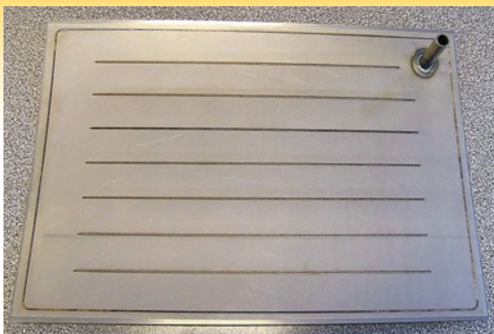
Figure 5: Application de micro-soudage laser. L'objectif de cette étude était la réalisation d'un démonstrateur d'un absorbeur solaire
