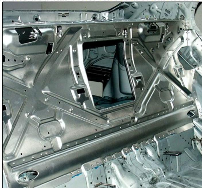
Figure 2: Clinchage dans la carrosserie d'une Mercedes classe S (source: Eckold)
