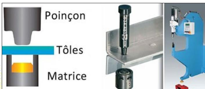
Figure 1 (en haut): Machine pour le clinchage (source: Kaho Sint-Lieven)
