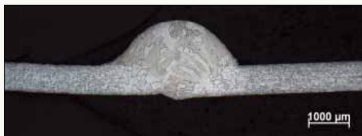
Figure 2: AISI430Ti 0,7 mm – procédé SP MAG-proces
