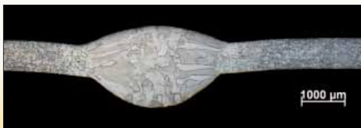
Figure 1: AISI430Ti 0,7 mm - procédé Cold Arc
