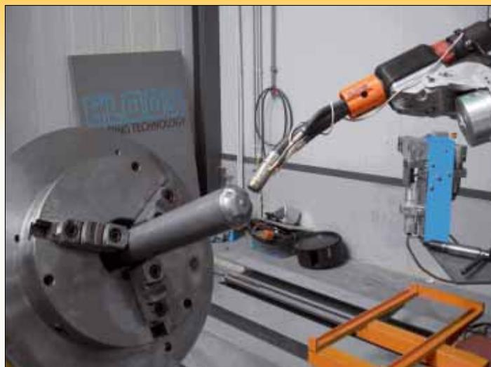
Figure 4: dispositif d'essai pour le soudage d'un amortisseur à 66° - Cold Process
