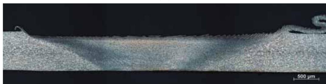
**Figure 6:** Coupe métallographique d'une soudure friction stir en 0,8mm 5754-H111, soudé à 0,5 m/min
