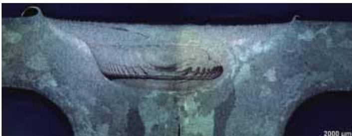
Figure 3.: Détail des angles de deux profils extrudés, joints par FSW
