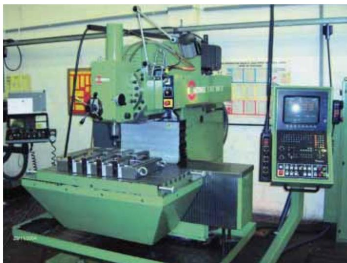
Figure 2.2 : Une des deux machines FSW disponibles au CEWAC
