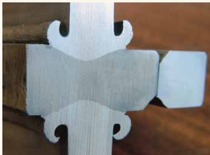
Aperçu d'une soudure typique
