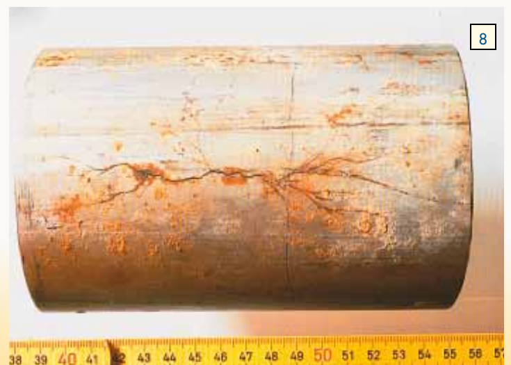
Figure 8: Cas de corrosion sous tensions dans un tube en AISI 316 due à une combinaison de tensions, chlorures et température après quelques mois de service
