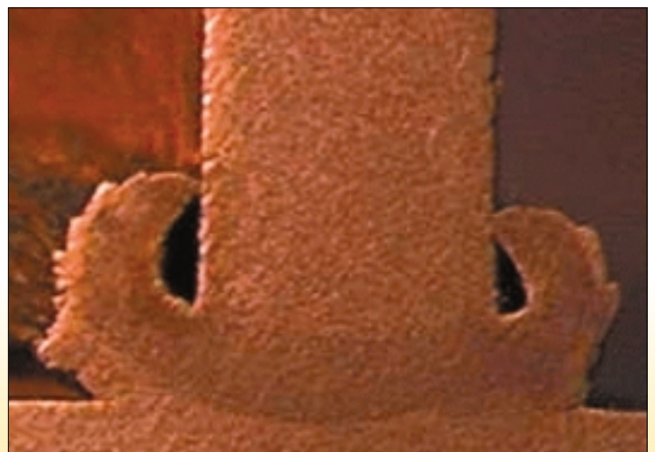
Figures 3 et 4: Comparaison de l'aspect modélisé (gauche) et réel (droite) de la soudure
