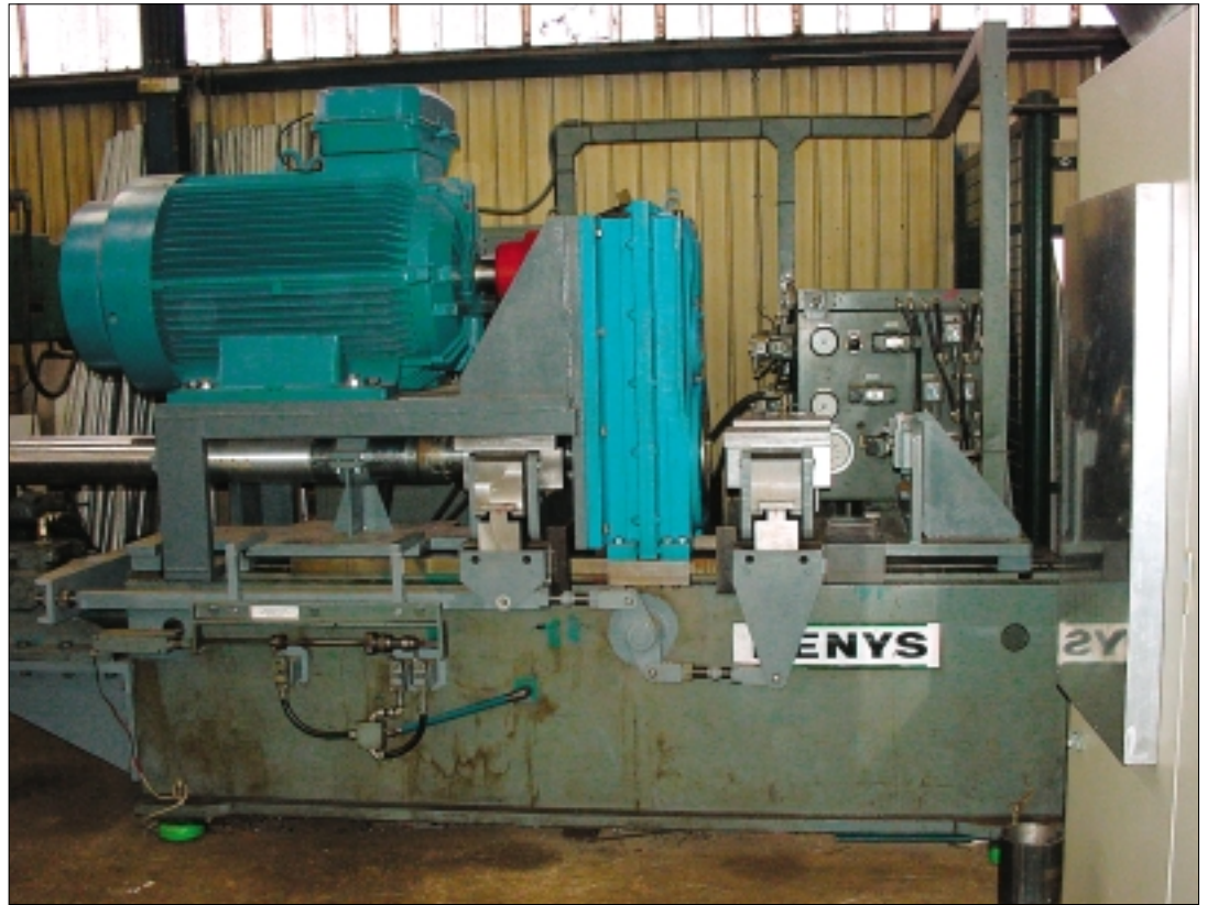
Disposition d'essai de la nouvelle variante du procédé de soudage par friction (Doc. IBS)
