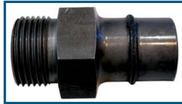
Figuur 7: las van een buis met een fitting: onderdeel van een grondverzetmachine (diameter: 27 mm, wanddikte: 3,2 mm, lastijd: 5 sec) (Bron: Paton Lasinstituut)
