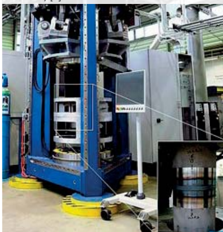
Figuur 12: MIAB-proefopstelling voor het lassen van boorbuisen (Bron: Leibniz Universiteit van Hannover) [2]
