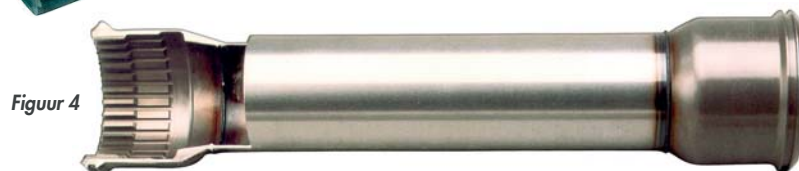
Figuur 2: dwarsdoorsnede van een MIAB-verbinding van twee pijpen (diameter: 44 mm, wanddikte: 3,6 mm) (Bron: Belgisch Instituut voor Lastechniek) Figuur 3: gelaste assen (diameter: 22 mm) (Bron: Paton Lasinstituut) Figuur 4: gelaste aandrijf-as (Bron: KUKA Industries GmbH)
