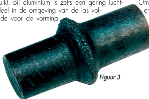
Figuur 2: dwarsdoorsnede van een MIAB-verbinding van twee pijpen (diameter: 44 mm, wanddikte: 3,6 mm) (Bron: Belgisch Instituut voor Lastechniek) Figuur 3: gelaste assen (diameter: 22 mm) (Bron: Paton Lasinstituut) Figuur 4: gelaste aandrijf-as (Bron: KUKA Industries GmbH)
