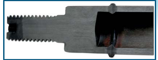
Figuur 7: las van een buis met een fitting: onderdeel van een grondverzetmachine (diameter: 27 mm, wanddikte: 3,2 mm, lastijd: 5 sec) (Bron: Paton Lasinstituut)
