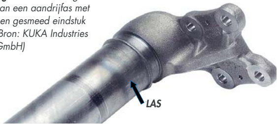
Figuur 7: las van een buis met een fitting: onderdeel van een grondverzetmachine (diameter: 27 mm, wanddikte: 3,2 mm, lastijd: 5 sec) (Bron: Paton Lasinstituut)
