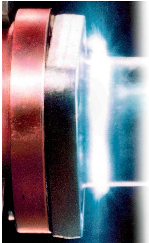
Figuur 1: principe van het MIAB-lasproces (Bron: KUKA Industries GmbH)
