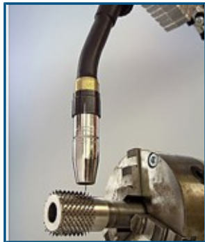
Figuur 9: Fronius TransPuls Synergic 3200 CMT G/W – CMT lastoestel dat pinnetjes lasdraad last www.algametal.com.tr
