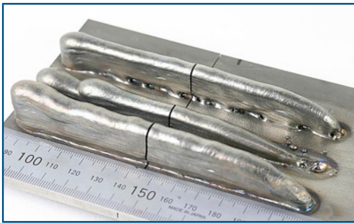
Figuur 8: voorbeeld van een opgebouwde 'muur' in Ti6Al4V met plasma-lassen met toevoegmateriaal [2]
