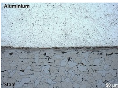
Figuur 7: Metallografische doorsnede van een aluminium-staallasverbinding (Bron: Belgisch Instituut voor Lastechniek)
