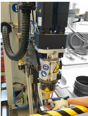
Figuur 10: Wrijvingspuntlastoestel aanwezig in het Belgisch Instituut voor Lastechniek
