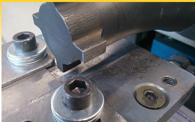
Figuur 9: sonotrode bij het ultrasoon puntlassen (bron: Belgisch Instituut voor Lastechniek)
