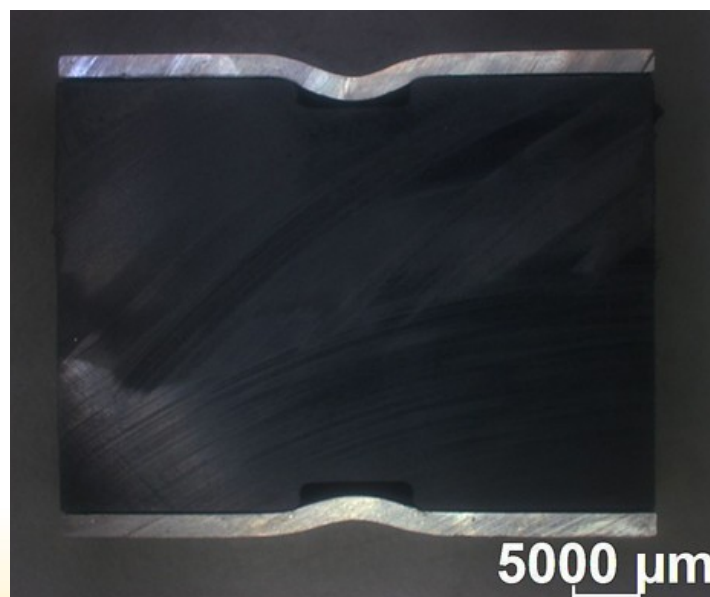
Figuur 13: verbinding tussen een composietstaaf en een alubuis (bron: Belgisch Instituut voor Lastechniek)
