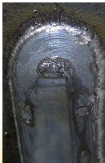
Fig. 1: monster voor vermoeiingstest; in het centrale gedeelte is er aan beide zijden een 'vin' gelast. Detail: met HFMI behandelde lassteen
