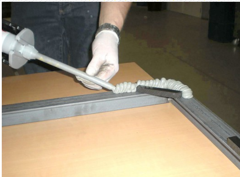
Figuur 1: voorbereiding van de verlijming van een polycarbonaat paneel op het stalen profiel van een testframe (Bron: Flanders Drive)
