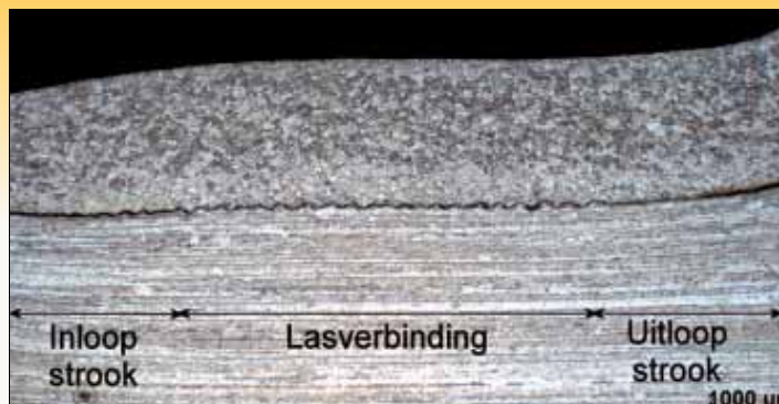
Figuur 4: Macrografische doorsnede van een magnetische pulslas (detail van figuur 3)
