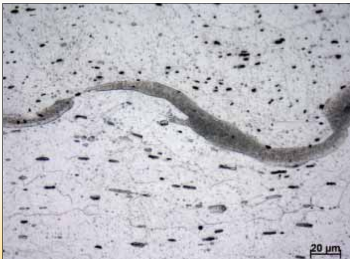
Figuur 5: Metallografische doorsnede van de verbinding getoond in figuur 4
