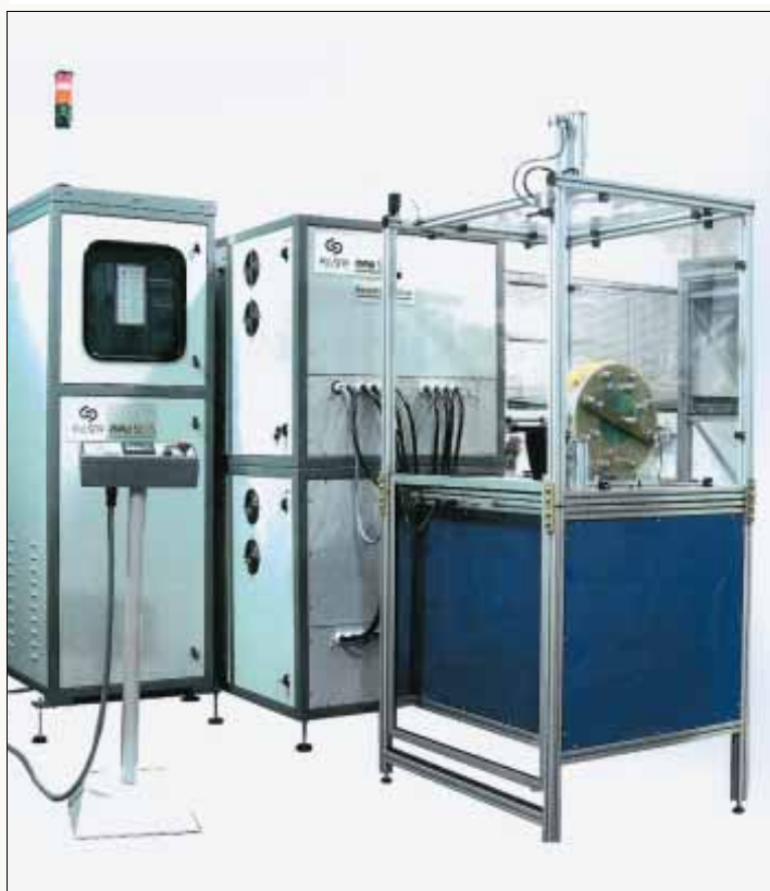
Figuur 2: proefopstelling van het BIL (bron: Pulsar Ltd.)
