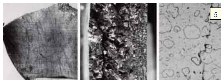
Figuur 3: Een gietstuk in AISI 316 werd te traag afgekoeld. Als gevolg daarvan werd het delta-ferriet in de austenietmatrix grotendeels omgezet tot sigma-fase (de donkere tweede fase). Op sommige plaatsen is nog intact deltaferriet zichtbaar –dit is iets lichter dan de sigma-fase Figuur 5: Gebroken duplex roestvast stalen onderdeel uit een harsinstallatie. Dit stuk werd elke 2 maand gereinigd gedurende een uur bij 420-450°C. Na 2 jaar resulteerde dit in "475°C verbrossing". Links wordt getoond hoe de scheur doorheen het ferriet loopt. en het taaiere austeniet vermiid
