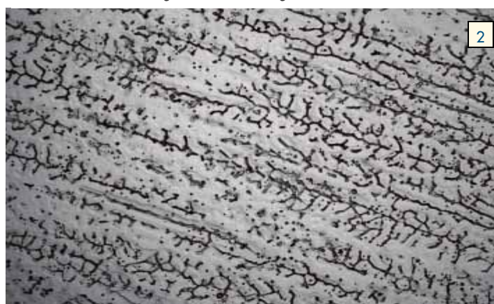
Figuur 2: Type AISI 304 lasmetaal met enkele procenten delta-ferriet
