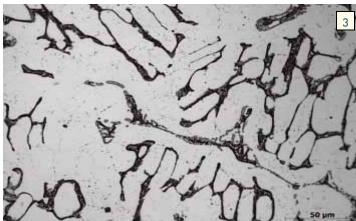
Figuur 3: Een gietstuk in AISI 316 werd te traag afgekoeld. Als gevolg daarvan werd het delta-ferriet in de austenietmatrix grotendeels omgezet tot sigma-fase (de donkere tweede fase). Op sommige plaatsen is nog intact deltaferriet zichtbaar –dit is iets lichter dan de sigma-fase Figuur 5: Gebroken duplex roestvast stalen onderdeel uit een harsinstallatie. Dit stuk werd elke 2 maand gereinigd gedurende een uur bij 420-450°C. Na 2 jaar resulteerde dit in "475°C verbrossing". Links wordt getoond hoe de scheur doorheen het ferriet loopt. en het taaiere austeniet vermiid
