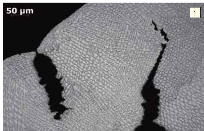
Figuur 1: Warscheuren in het lasmetaal van een gietstuk en een plaat, beide in AISI 316. Er werd met TIG gelast zonder toevoegmateriaal
