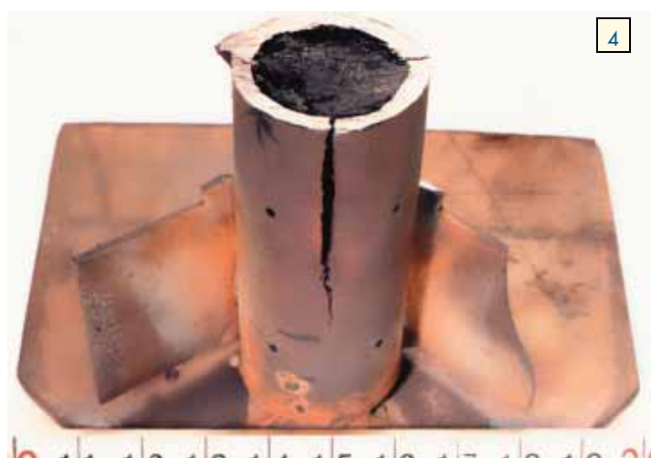
Figuur 4: Gescheurde AISI 310 buis in een kraakoven. Wegens verstopping met roet liep de temperatuur op tot in het sigma fase gebied. Door de optredende spanningen traden uiteindelijk interkristallijne scheuren op in het verbroste metaal
