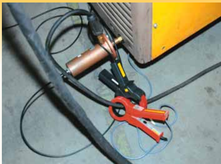
Figuur 2: De stroom en spanning werden op twee manieren opgemeten: d.m.v. een meettoestel (ALX) dat speciaal ontwikkeld werd om lasparameters op te meten (hierbij werd gewerkt met een stroomtang) en d.m.v. een shunt die in serie met de massakabel ingeschakeld werd. Het signaal afkomstig van de shunt werd op een oscilloscoop gevisualiseerd
