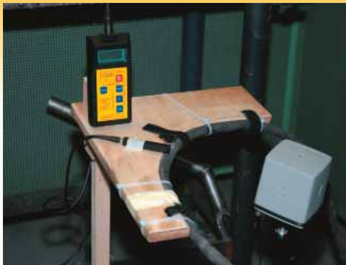
Figuur 5: Naast de stroommeting wordt het magnetisch veld opgemeten. Dit veld wordt volgens de norm gemeten in het middelpunt van een gekromde stroomgeleider (massakabel) met een straal van 20 cm
