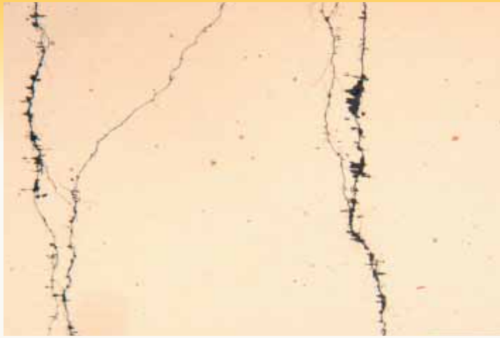
Figuur 9: Optreden van chloride spanningscorrosie in AISI 304 Ti gestabiliseerd roestvast staal. In de ongeëtte doorsnede (links) zijn de titaancarbidet precipitaten zichtbaar
