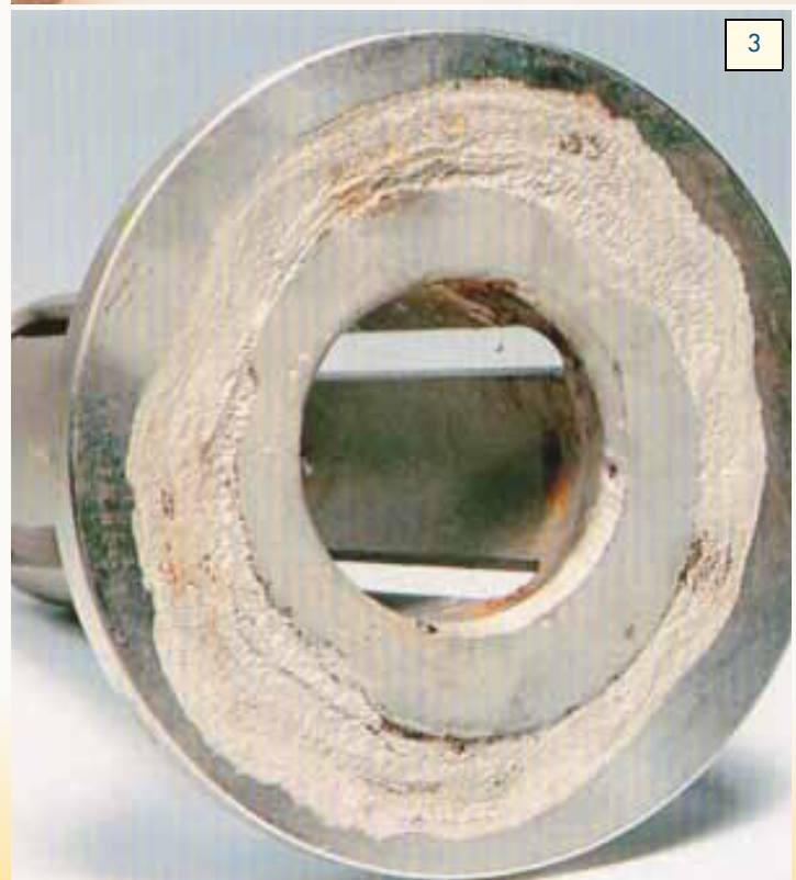
Figuur 1: uniforme aantasting roestvast stalen balustrade in een hotelhal Figuur 2: pitting van een AISI 316 condenser-onderdeel, werkend in zeewater Figuur 3: spleetcorrosie van een AISI 316 zeef (opererend in een zeewateromgeving), op de plaats van een afdichting
