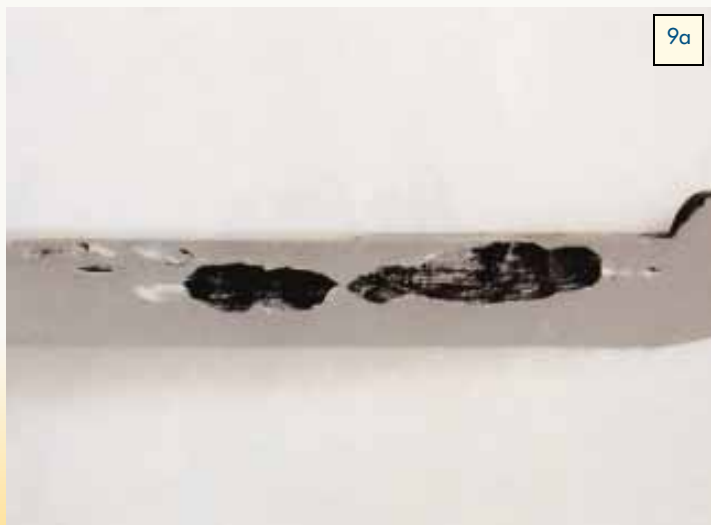
Figuren 9a en 9b: twee gevallen van microbiologische corrosie in AISI 304 materiaal
