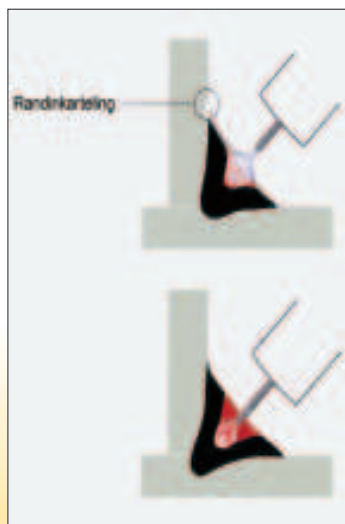
Figuur 2: Principe van het ForceArc-lasproces
