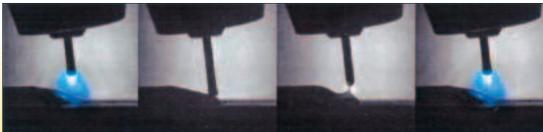
Figuur 7: schematische voorstelling van het CMT-proces met hierbij geïllustreerd het terugtrekken van de lasdraad
