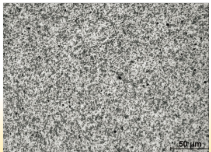
Figuur 6: Micrografieën van EN AC-46000-F basismetaleel (links) en het centrale gedeelte van de nugget (rechts). De dendrietstructuur van het basismetaleel is volledig afgebroken in de nugget
