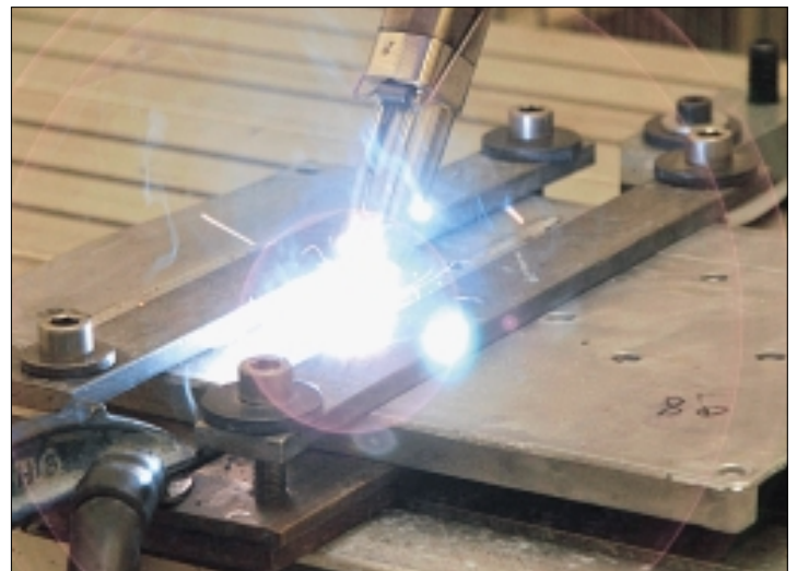
Figuur 2: HLW bij het Lasercentrum Vlaanderen (VITO): de aluminiumplaten worden door middel van een Fronius hybride laskop aan elkaar gelast
