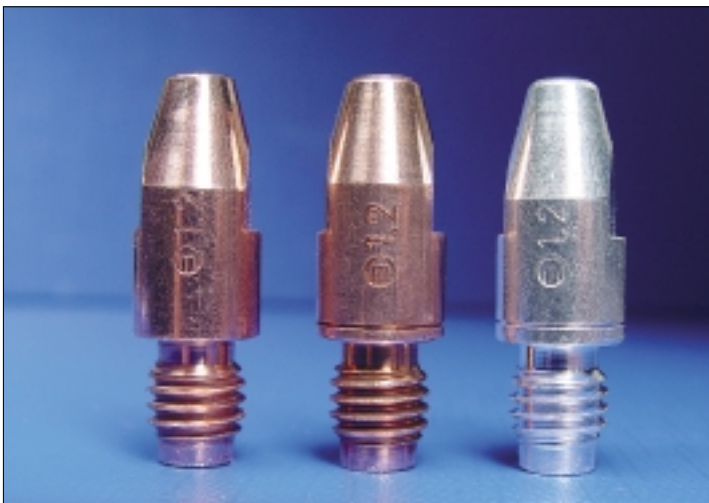
Figuur 4: contacttips: zuiver Cu, CuCrZr en verzilverd CuCrZr
