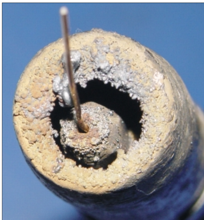
Figuren 7a en 7b: gascups met overdreven spatten en excentrische plaatsing van de contacttip in het mondstuk
