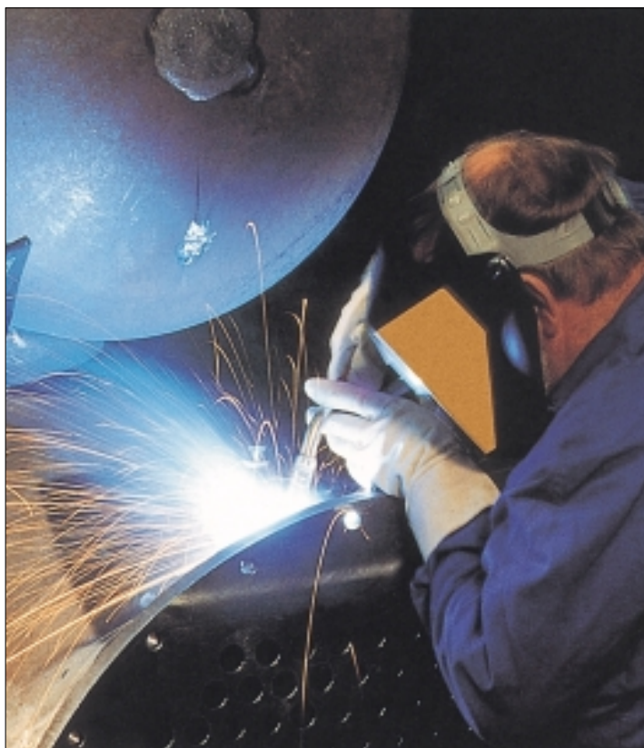
Bij het halfautomatisch lassen vormt er zich een elektrische boog tussen het continu aangevoerde en afsmeltende draadtoevoegmateriaal en het werkstuk (foto Patrick Van Hulst)
