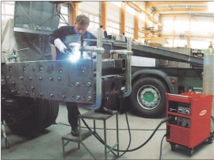
Toepassingen van MIG/MAG-lassen variëren van gewoon laaggelegeerd staal en rvs tot aluminium en andere non-ferro legeringen (foto Peter Veldeman)
