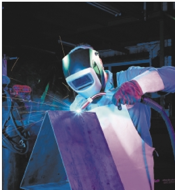
De universele inzetbaarheid van het MIG/MAG-lassen - wat betreft dikte, materiaalsoorten, naadvormen en lasposities - verklaart zijn succes in de metaalverwerking (foto Jan Laerte)
