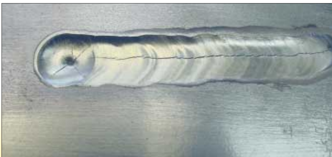
Figuur 5: Voorbeeld van een stollingscheur in het hart van een TIG-gelaste aluminiumverbinding (extrusielegering met 0,8% Si)
