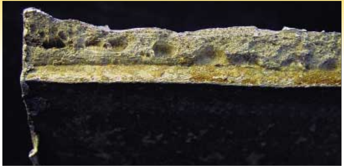
Figuur 2: Voorbeeld van een poreuze lasverbinding
