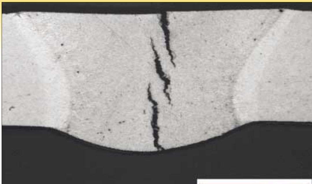
Figuur 6: Doorsnede van een stollingsscheur (Keller's reagens)
