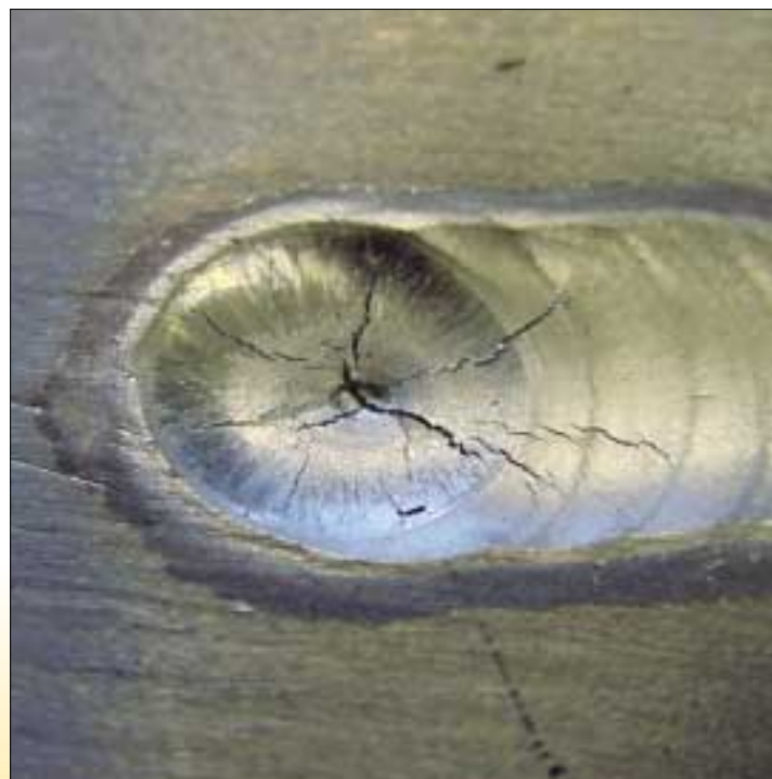
Figuur 7: Voorbeeld van een typische eindkraterscheur
