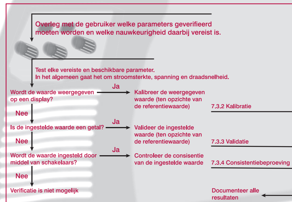
Figuur 1 Stroomschema voor bepaling van de verificatiemethode
