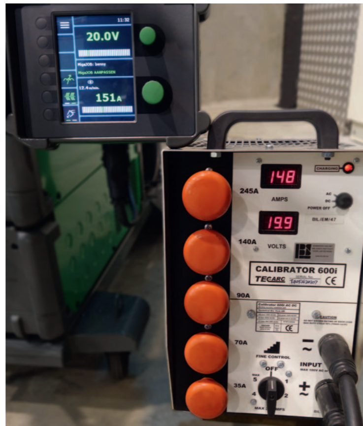
Figuur 2 Testopstelling voor de kalibratie van een MAG-apparaat met een weerstandsbank
