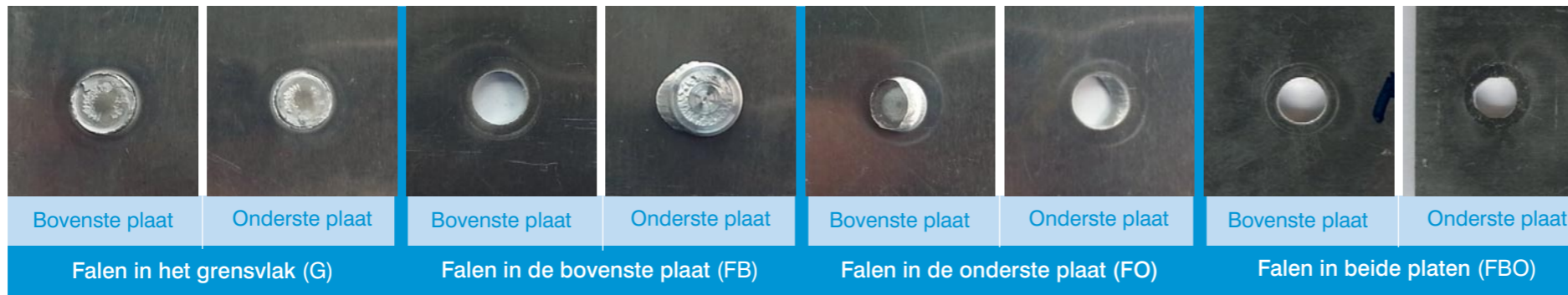
Figuur 7 Verschillende faalmechanismen tijdens de afschuif- en koptrekproeven
