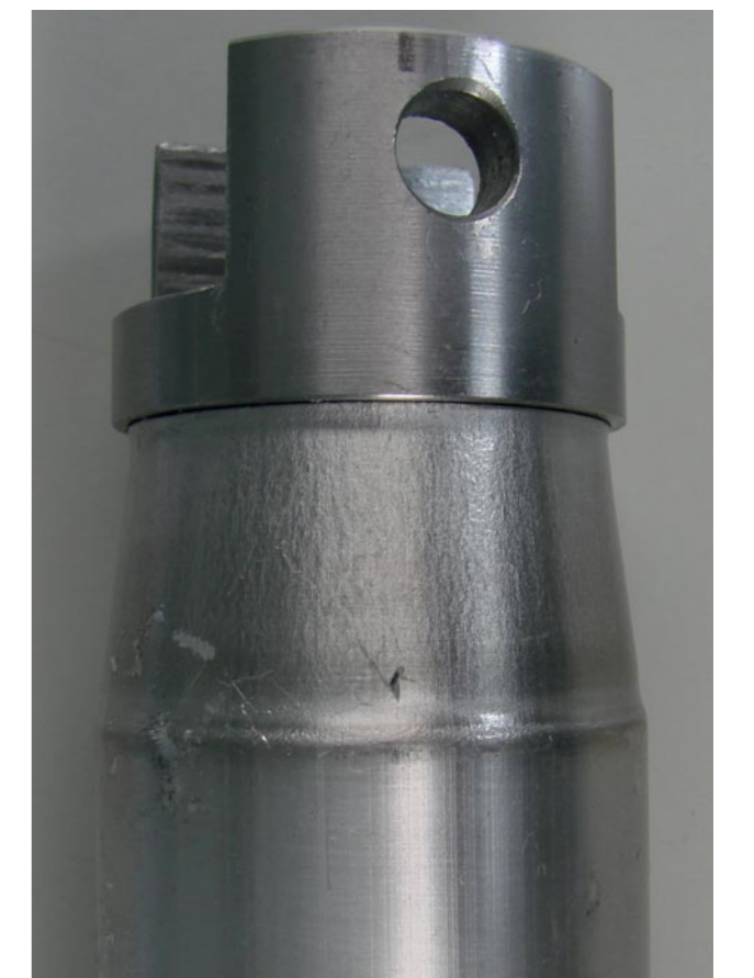
Afb. 5 Elektromagnetische pulslas van aluminium aan staal in een drijf-as voor de automobiellindustrie (PST products GmbH, Duitsland)
