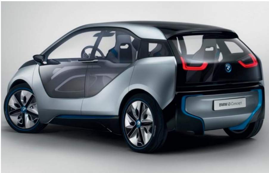
Afb. 1 BMW i3 - Eerste elektrische auto vervaardigd uit koolstofvezelversterkt composiet en aluminium
