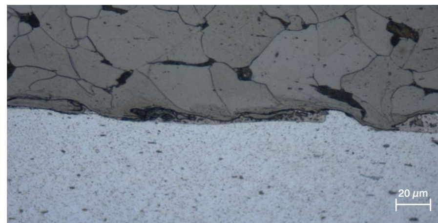
Ab. 3 Lasinterface van een aluminium – staal las (links) en koperstaal las (rechts) via elektromagnetische pulstechnologie
