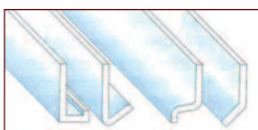
Hoeken en ogen waarin vuil en water zich kunnen ophopen moeten worden vermeden.
