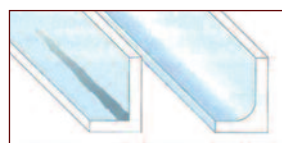
Het risico van vuilophoping wordt verkleind door afgeronde hoeken.
