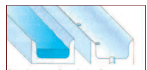
Stilstaand water wordt voorkomen door een geschikte helling van de profielen of door afvoergaten (min. ø 8 mm of 6 x 20 mm, capillaire werking). Door ventilatie van 'gesloten' constructies neemt de kans op condens af.
