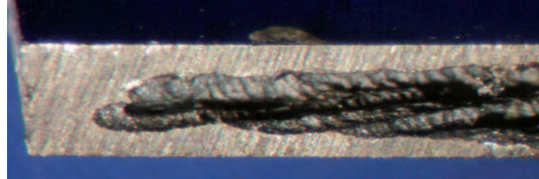
Figuur 6a: macrofoto van een dwarsdoorsnede van de plaat
