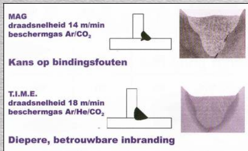
Figuur 1 : Vergelijking van het T.I.M.E.-lassen met het conventionele MIG/MAG-lassen
