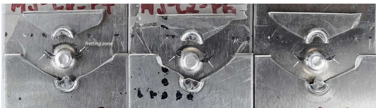
Figuur 3: Verschillende clinch verbindingen na een vermoeiingsproef, fretting zone is duidelijk zichtbaar op alle proefstukken.
