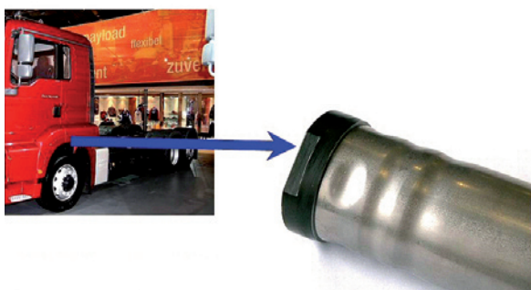
Figuur 7 - Krimpverbinding in een bevestigingsstuk van een zijvleugel op een vrachtwagen [6]
