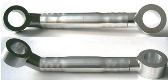
Figuur 8 - Onderdeel voor de automobiellindustrie, vervaardigd via magnetisch pulskrimpen [8]
