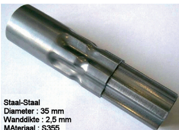
Figuur 9 - Magnetisch pulskrompen aandrijf-as [7]
