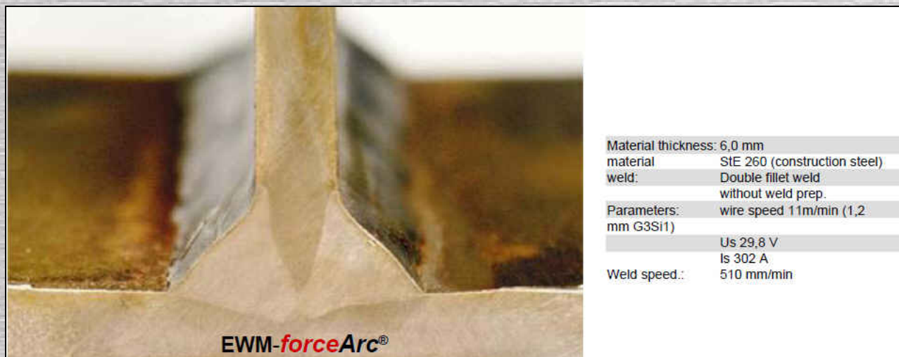
Figuur 2 : EWM ForceArc gelaste T-naad.
