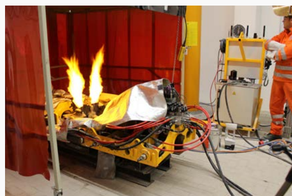
Nieuwe variant van het aluminothermisch lassen
