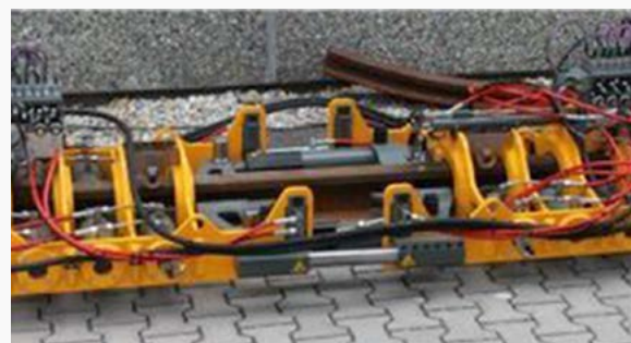
Nieuwe variant van het aluminothermisch lassen
