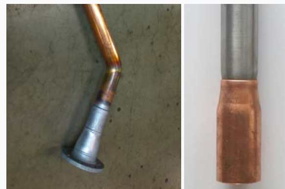
Demonstratiestuk voor REFCO: Koper-staal buisverbinding (links) m.b.v. braseren (recht) m.b.v. elektromagnetisch puls lassen
