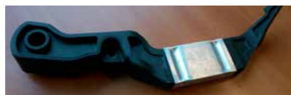
Prototype van een hybride rempedaal, vervaardigd met de elektromagnetische puls technologie
