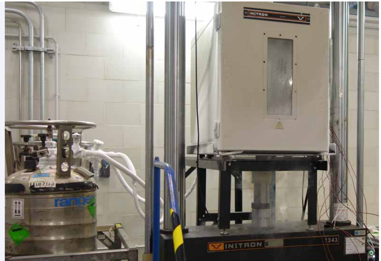
Klimaatkast opgesteld voor het beproeven van 9%Ni staal bij -165°C, koeling van de proefstaven door verneveling van vloeibare stikstof
