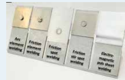
Demostukken voor materiaalcombinatie 1: aluminium/staal
