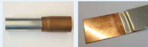
Elektromagnetisch pulslasverbindingen van koper aan aluminium
