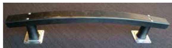
Prototype van een hybride bumper, vervaardigd met de elektromagnetische puls technologie
