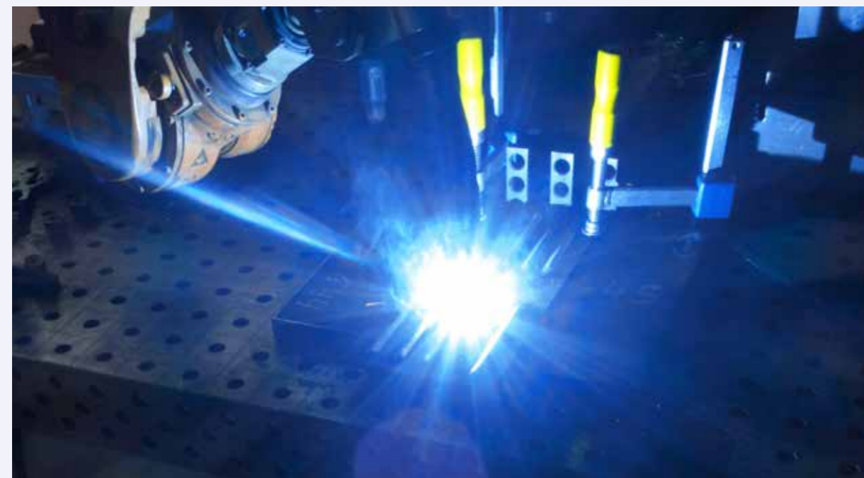
Het nieuwe lasparameter registratie toestel in werking
