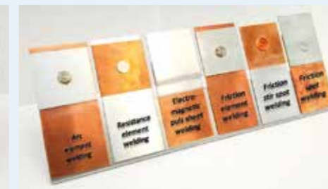
Demostukken voor materiaalcombinatie 2: aluminium/koper
