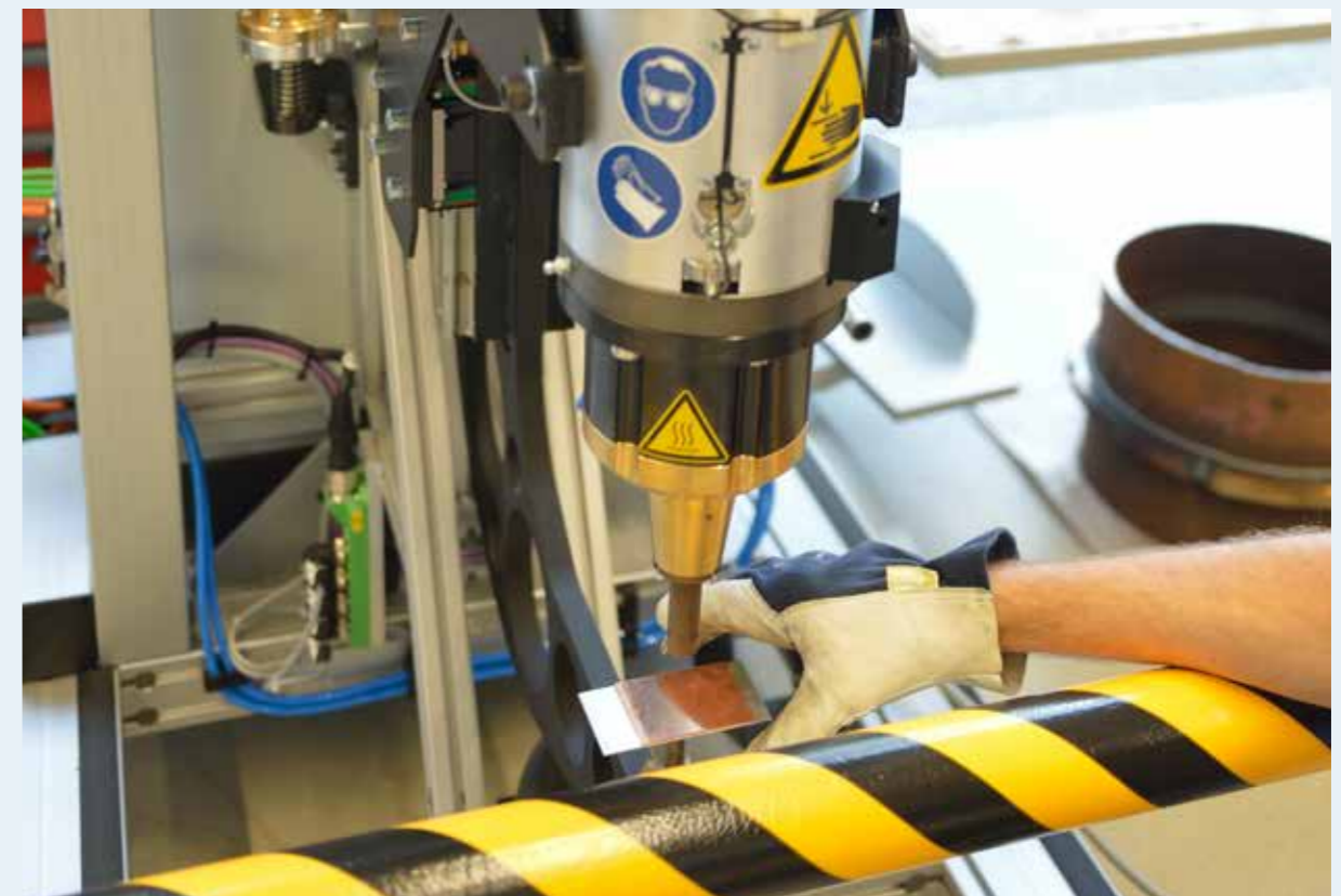
Wrijvingspuntlastoestel aanwezig in het Belgisch Instituut voor Lastechniek
