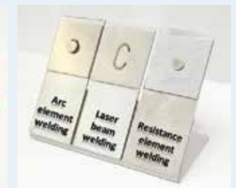
Demostukken voor materiaalcombinatie 3: hoogsterkte staal/roestvast staal
