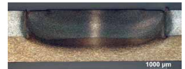
Coupe de soudage d'un assemblage d'aluminium EN AW-2024 et 7475
