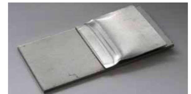
Soudage par impulsion magnétique d'aluminium EN-AW 1050 et de l'acier S235
