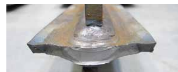
↑ rupture par fatigue
