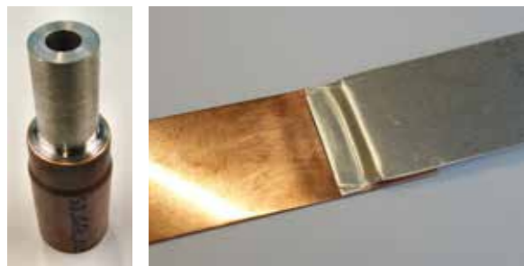
↑ Soudage par impulsion électromagnétique du cuivre sur l'aluminium
