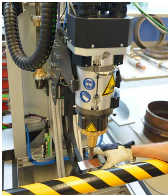
Wrijvingspuntlastoestel aanwezig in het Belgisch Instituut voor Lastechniek
