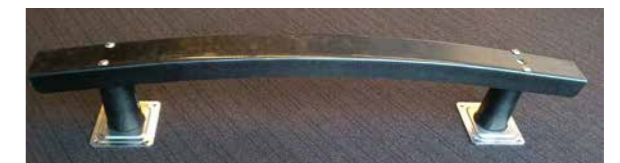
⬆️ Prototype van een hybride bumper, vervaardigd met de elektromagnetisch pulstechnologie
