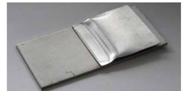
Pulsasverbinding tussen een aluminium EN-AW 1050 en staal S235 plaat
