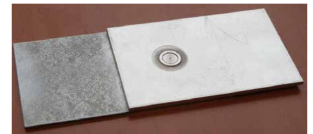
Wrijvingspuntlasverbinding van aluminium EN AW-6082 en gegalvaniseerd staal
