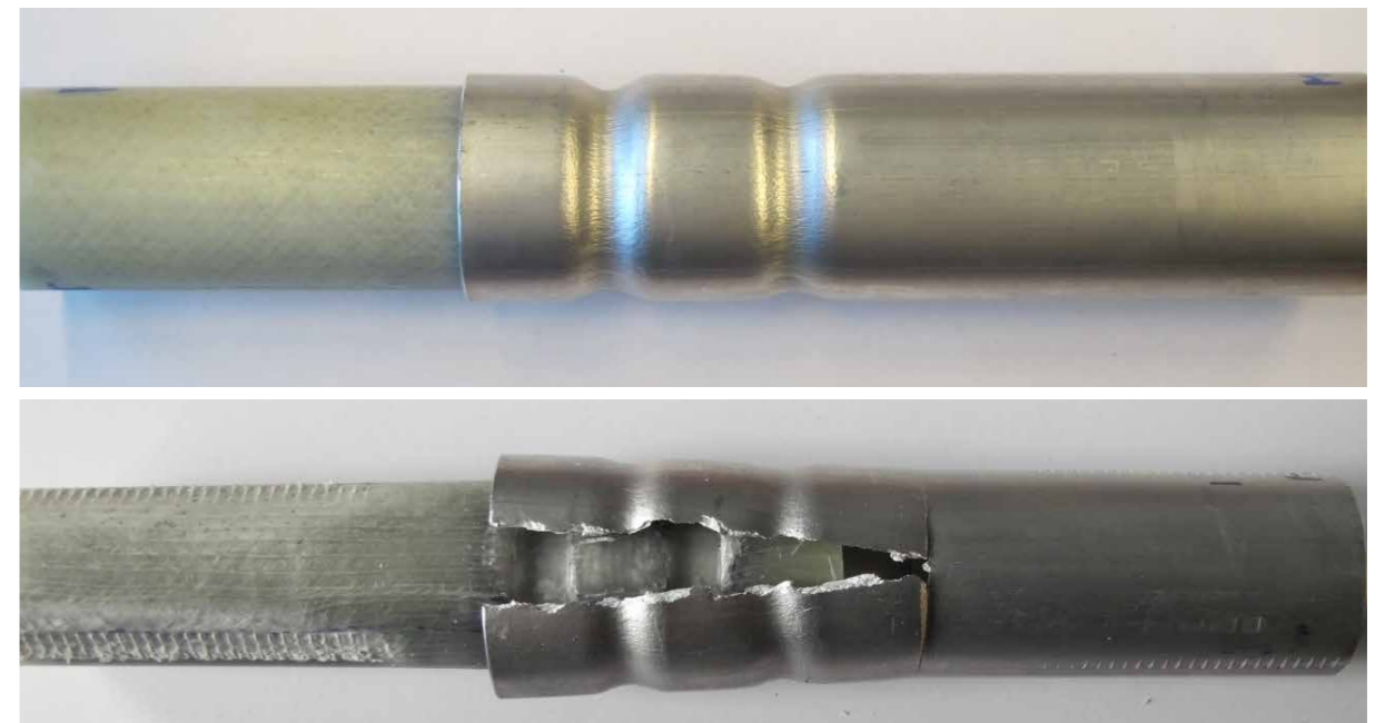
⬆️ Krimpverbinding van aluminium EN AW-6082 en een continue glasvezel versterkte composiet, geproduceerd door resin transfer molding, vòòr en na het uitvoeren van een trekproef
