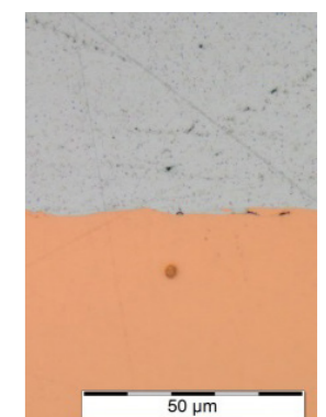
Figure 6: Jonction d'une soudure par impulsion d'une tôle en aluminium et en cuivre
