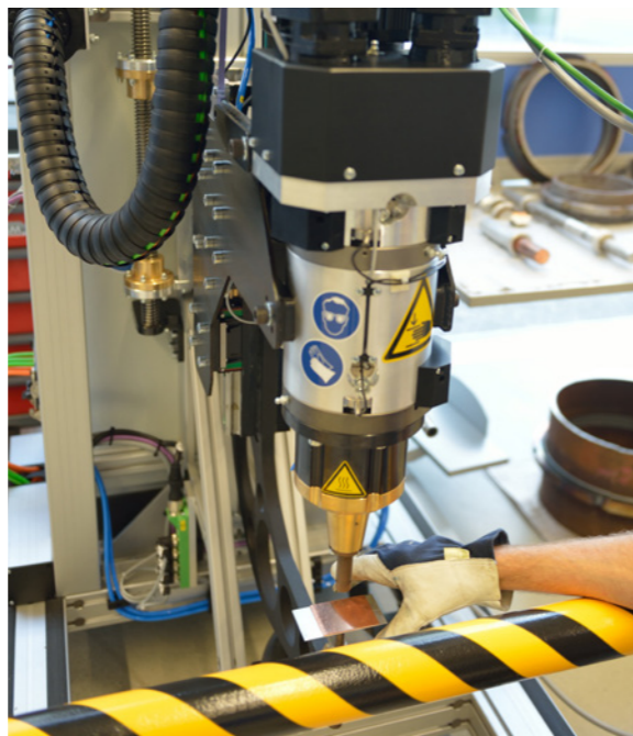
Figure 2: Appareil de soudure par friction par points présent à l'Institut Belge de la Soudure
