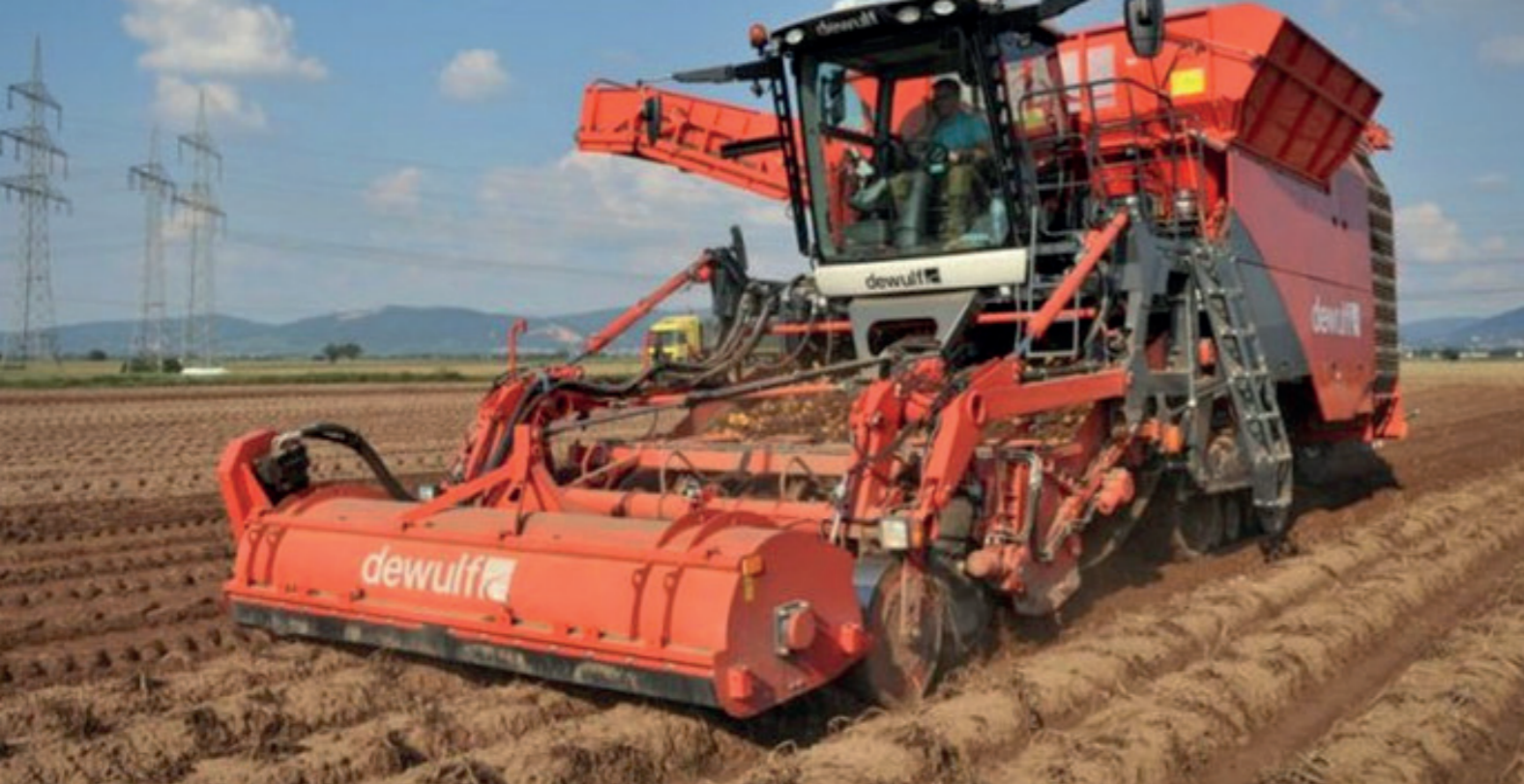
⬆ De vermoeingslevensduur van de stuurinrichting van deze aardappel oogster werd met een factor 6.5 verlengd
